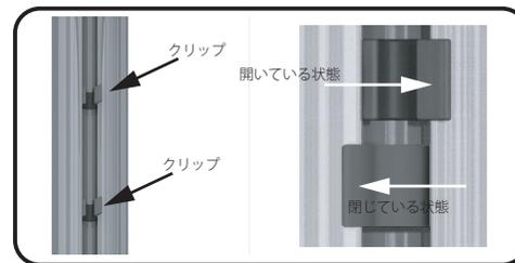
キーボード用の電源ケーブルをスタンド中央の溝にセットし、図のクリップを締めて固定します。
