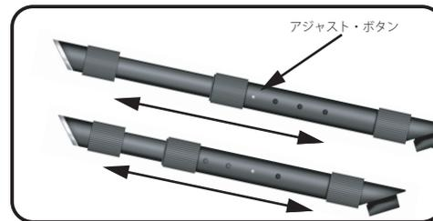
アームの長さを調整するにはアームの下面にあるボタンを押しながら好みの位置にスナップさせます。
