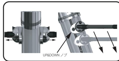
高さを調整するには図のUP & DOWN ノブを左右同時に引っ張り、上下に動かして位置を決めます。位置がきまりましたらノブを離し、確実にロックされていることをしっかり押して確認してください。
