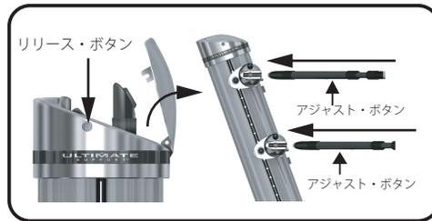
スタンド頂上部の赤いリリースボタンを押してキャップを開きます。アームを全て引き出し、図のように位置にスタンド本体へ差し込みます。このときアジャスト・ボタンが下向きになり、ロゴが正面を向く方向にあるかを確認し、アームが固定されたかどうかを充分に確認してください。
