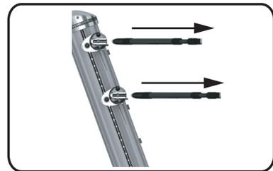
アームの下の赤いボタンを押して、アームを引き抜きます。頂上部にある赤いボタンを押してキャップを開け、アームを全て収納します。
