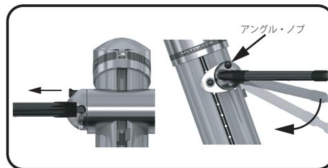
アームの角度を調整するには図のアンクル・ノブを引っ張りながら左右それぞれにスナップする位置に調整します。この作業を全てのアームについて調整してください。
